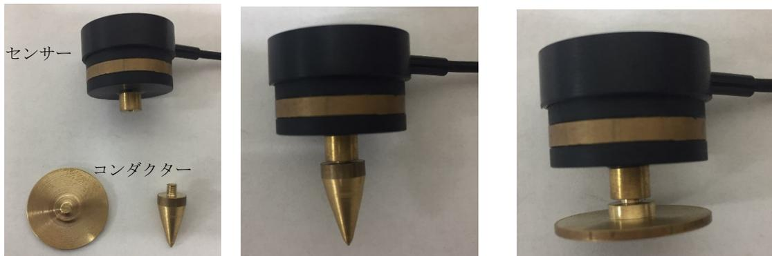
微小振動を受けるセンサー端部は M3 のネジにより 2 種類のコンダクターを取り付ける事が可能。 微小振動発生源の形状によりピックアップセンサーのコンダクターの選択が可能。
