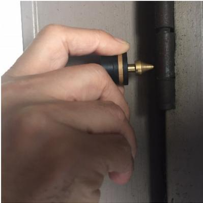
コンクリートで施工された壁面でも扉の蝶つがい部分は壁面向こう側の微小振動を効率よく取ることが出来ます。
