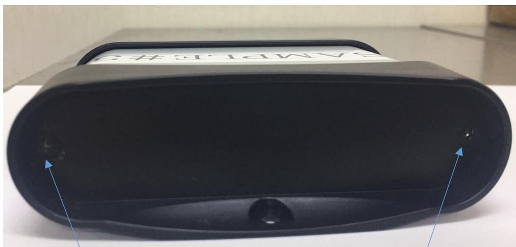
電池交換は裏フタネジを外すと電池交換が出来ます
