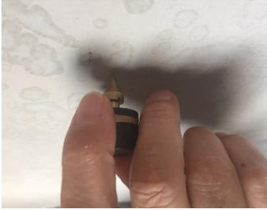
コンクリートで施工された壁面は鉄骨が中に配置されています、その為鉄骨が配置されている部分は建屋全体の微小振動を捉えてしまいます、壁面向こう側の微小振動を捉えたい時は、鉄骨間だとある程度の微小振動を捉えることが可能なので位置を変えてみてください。
