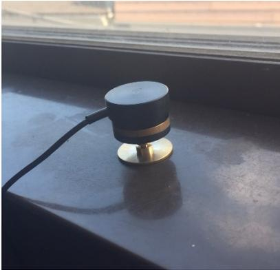
窓枠のサッシ、壁面と完全に固着されていないサッシ（手で叩くと固着状態がわかります）は外部の微小振動を多く取り入れています、その為外部騒音がない状態の環境の場合、サッシからも隣室の微小振動を捉えることができます。
