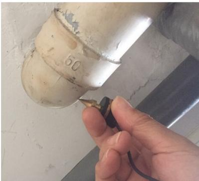
配水管から配水管端部からの微小振動を捉えることが出来ます。配水管端部からの距離が大きいと微小振動を捉えることが難しくなります。
